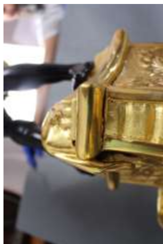
Fot. 21. Gerydon MK 2889, rozległe pęknięcie pod górnym gzymsem podstawy.
