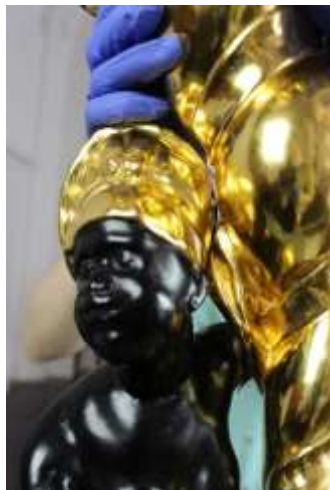
Fot. 4. Gerydon MK 2889, pęknięcia na styku lewej strony nakrycia głowy i ramienia z rogiem po przyłożeniu obu fragmentów.
