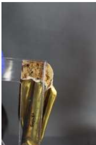
Fot. 16. Gerydon MK 2889, przełomy na styku szarfy z podstawą, wymiary.
