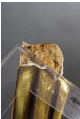
Fot. 16. Gerydon MK 2889, przełomy na styku szarfy z podstawą, wymiary.
