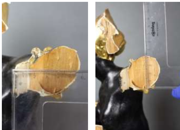
Fot. 8. Gerydon MK 2889, przełomy na styku ramienia z rogim, wymiary.
