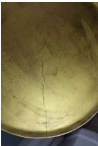
Fot. 24. Gerydon MK 2889. Fot. A: odprysk na kwiatach pod talerzem. Fot. B: pęknięcie na płaszczyźnie talerza.
