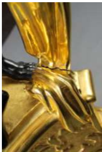
Fot. 17. Gerydon MK 2889, przełomy na styku szarfy z podstawą po przyłożeniu fragmentów.
