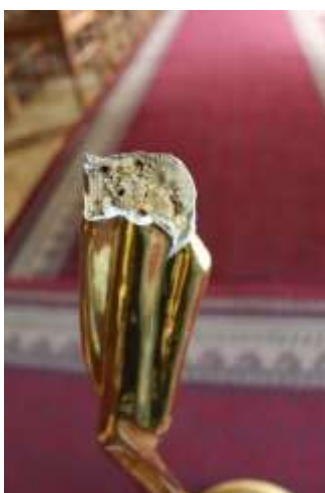
Fot. 15. Gerydon MK 2889, przełomy na styku szarfy z podstawą.
